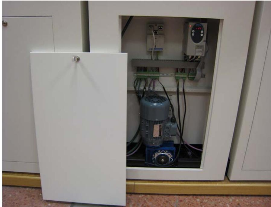
Los módulos tienen en su parte delantera una puerta cerrada por llave desde la que se accede a los elementos eléctricos y electrónicos de control y a los motores.
