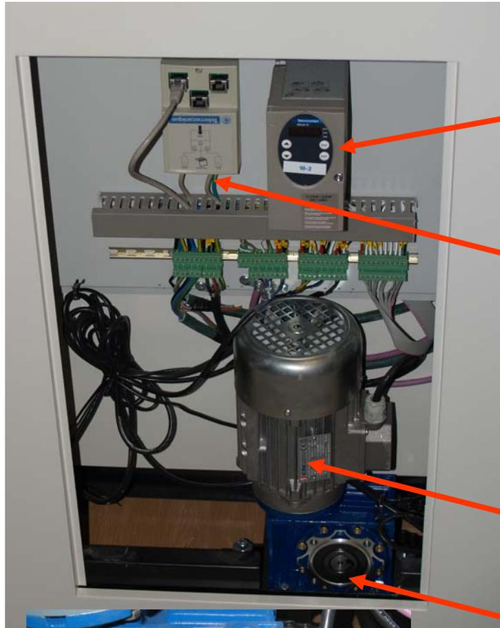
Control electrónico de velocidad del motor - permite el arranque y la frenada con gran suavidad.
