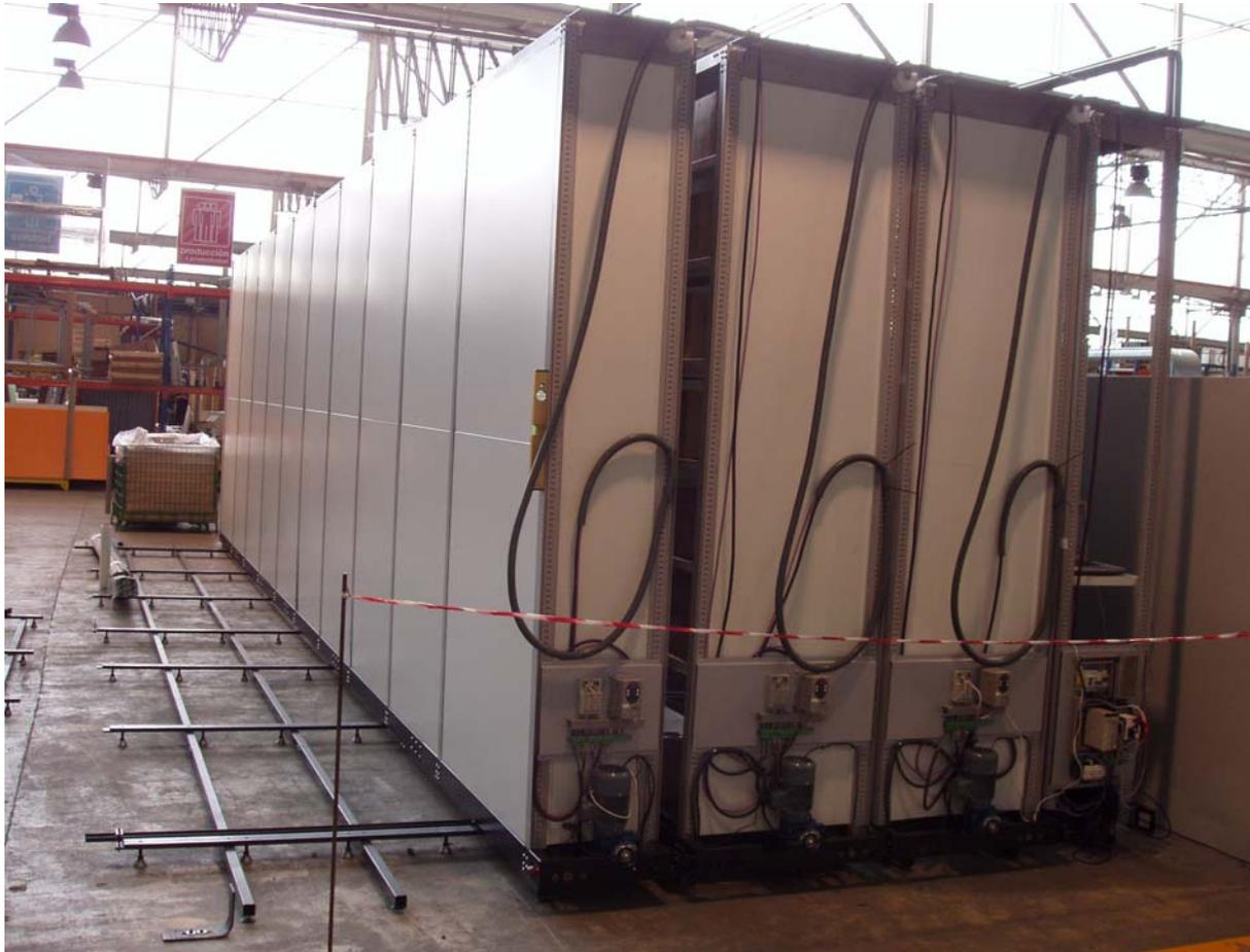
EL Ofita Blok se somete durante un mes a miles de movimientos, para comprobar su fiabilidad y seguridad.
